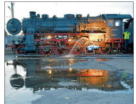
Die 58 311 schafft sich ihr eigenes Spiegelbild. Undichte Stellen an den Stehbolzen müssen repariert werden. Foto: Harald Belz
