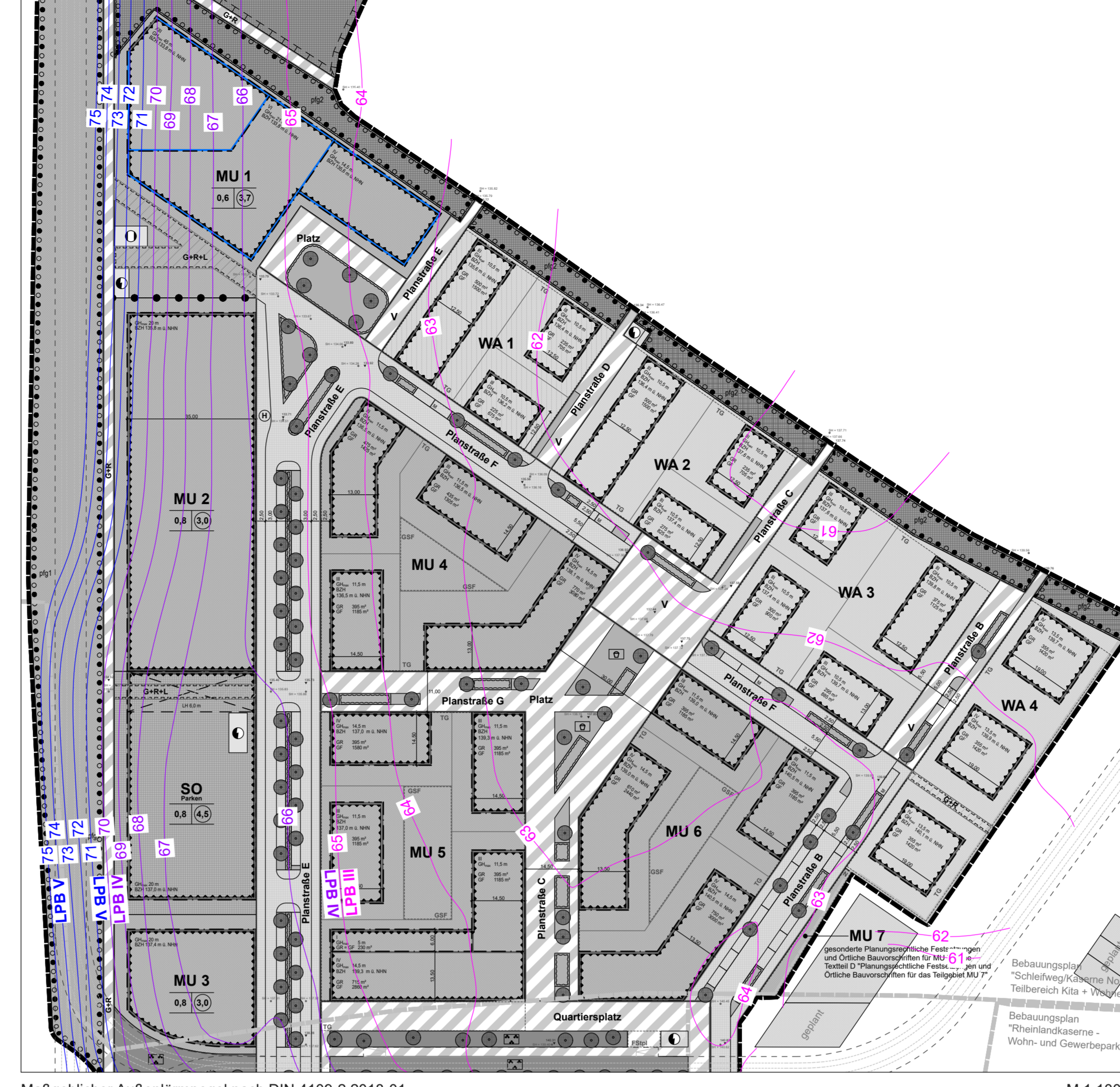
Maßgeblicher Außenlärmpegel nach DIN 4109-2:2018-01 Freie Schallausbreitung Lärmisophon H = 4,0 m Nachtzeitraum
