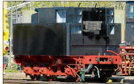
Der Tendaraufbau ist auf dem Rahmen aufgesetzt. Bevor der Tender mit der Lok gekuppelt werden kann, sind noch einige Detailarbeiten nötig.
