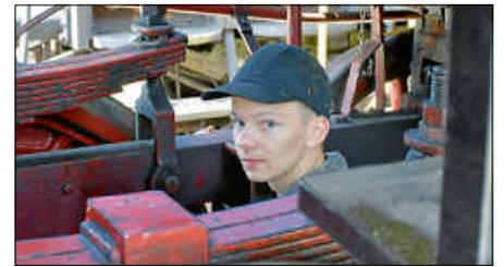
*Samuel ist in das Innere der Dampflokomotive 311 geklettert, um deren Innentriebwerk zu überprüfen, zu schmieren und ggf. Schrauben festzuziehen.*
