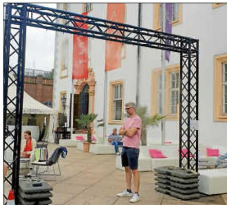
Dieser Torbogen erzielt große Wirkung: der Sprühnebel senkt die Temperaturen in der Umgebung um bis zu zwölf Grad - und das bei überschaubarem Wasserverbrauch von 10-15l/h.
