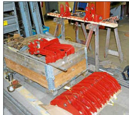
Auf das Anheben der 86 muss man noch etwas warten. In der Zwischenzeit werden die abgebauten Teile bereits entrostet, grundiert und neu gestrichen. Foto: Harald Belz
